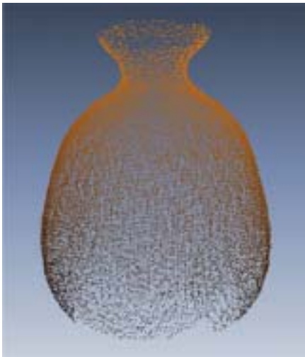
ステレオ写真群から生成した 3次元点群データ
